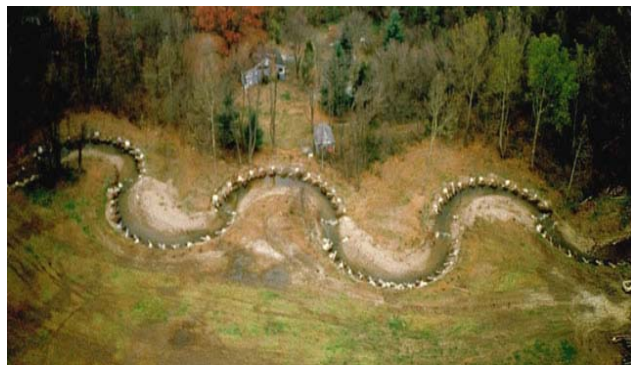
Meandros suformuotos iš akmenų
